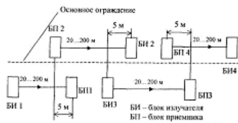
Вариант 1. Блокировка основного ограждения извещателями линейными радиоволновыми
